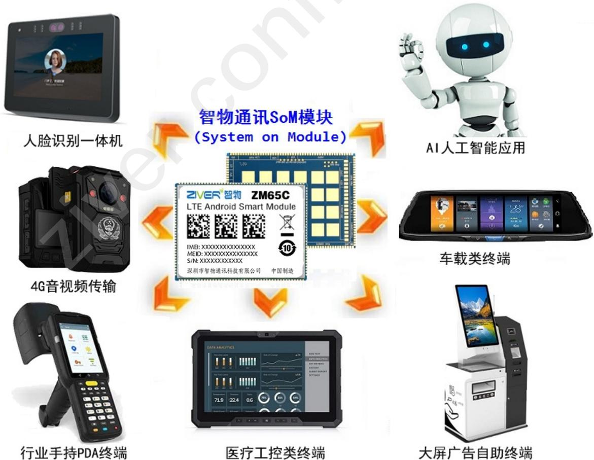
ZM65C 模块和 ZM358 系列模块尺寸规格一样，仅为 38.5mm x 52.5mm x 2.95mm，适合各类对结构尺寸要求更高的产品。产品广泛应用于 4G 音视频传输、智能手持终端、智能车载设备、机器视觉与机器人、智能信息采集设备、智能 POS 收银机、安防监控、行业平板、医疗与工业设备以及其他行业应用设计等多种领域。
